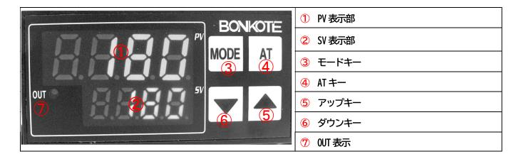
① PV 表示部 : ヒーター温度表示/キャラクター表示② SV 表示部 : 設定温度表示/各パラメータ値表示
